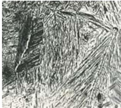
Figura 7: Microestructura acicular de la martensita
