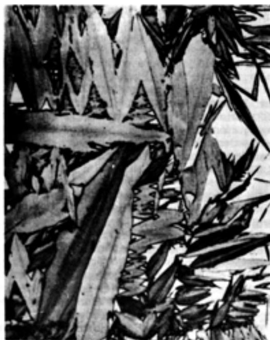
Estructura de un acero con 30% de Ni mostrando Placas de Martensita.
