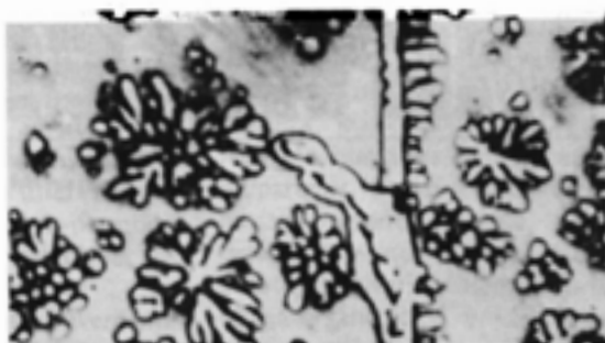
Fig. 4. Cu-12% Al en peso. Templada desde 900^\circ\text{C} en un baño de plomo a 508^\circ\text{C} , mantenida ahí por 120 seg. y luego templada en agua. Se observan dominios ordenados ( \text{Cu}_3\text{Al} ) en una matriz desordenada. En el interior de la zona ordenada que nace del borde de grano se aprecian pequeños precipitados de la fase \alpha x 1000.
