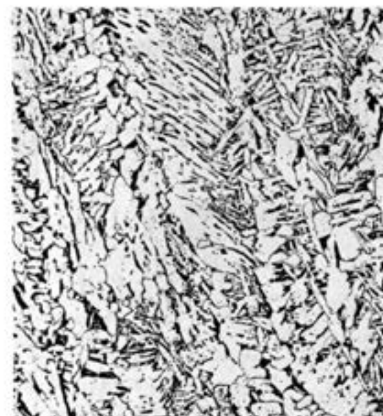
Fig. 7 Estructura de la zona de metal depositado en un acero soldado (250x)
