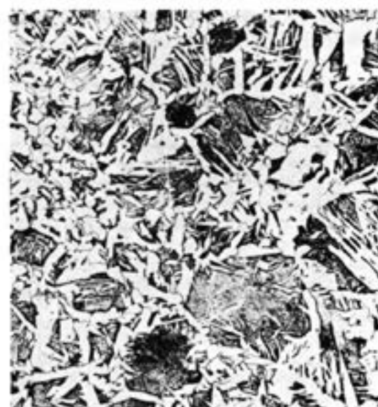
Fig. 5 Estructura de la zona de grano grueso en un acero soldado (250x)
