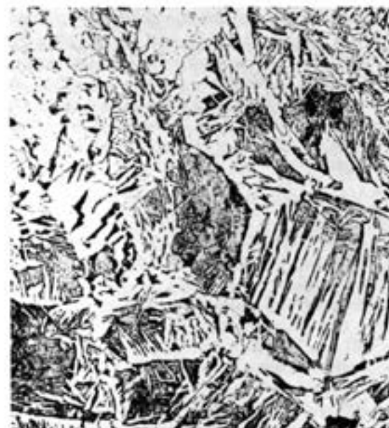
Fig. 6 Estructura de la zona de grano grueso y de fusión en un acero soldado (250x)
