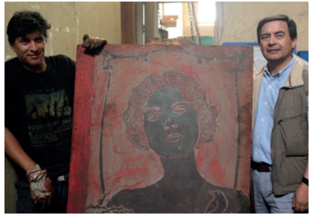
Figura N° 11: 1° Placa de acero obtenidas por el método del Electrograbado.
