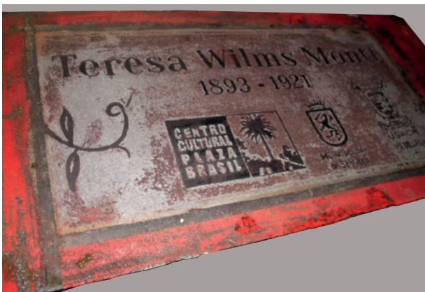
Figura N° 12: 2° Placa de acero obtenidas por el método del Electrograbado.
