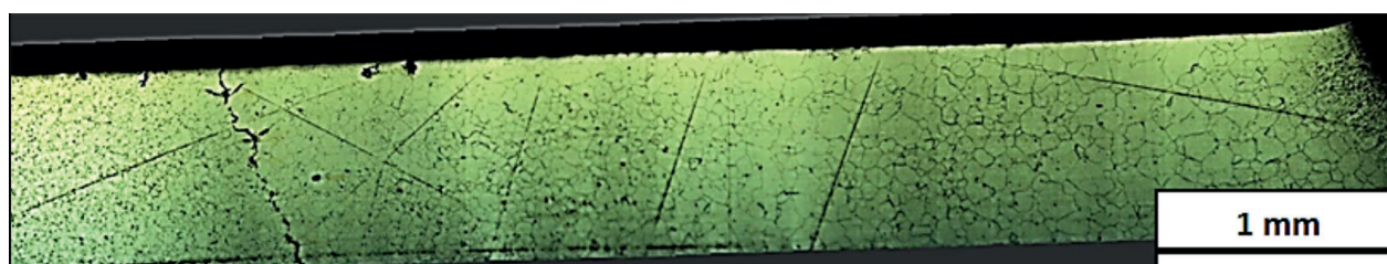
Figura N° 13. Grieta en el material base, desde la superficie del cilindro hacia el interior. Aproximadamente a 5 mm de la zona de fractura y soldadura. Imagen lograda por superposición secuencial de fotografías.
