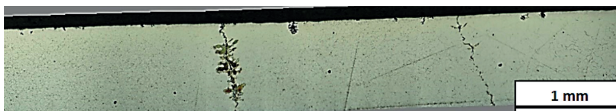
Figura N° 14. Grieta en el material base, desde la superficie del cilindro hacia el interior. Aproximadamente a 8 mm de la zona de fractura y soldadura. Imagen lograda por superposición secuencial de fotografías.
