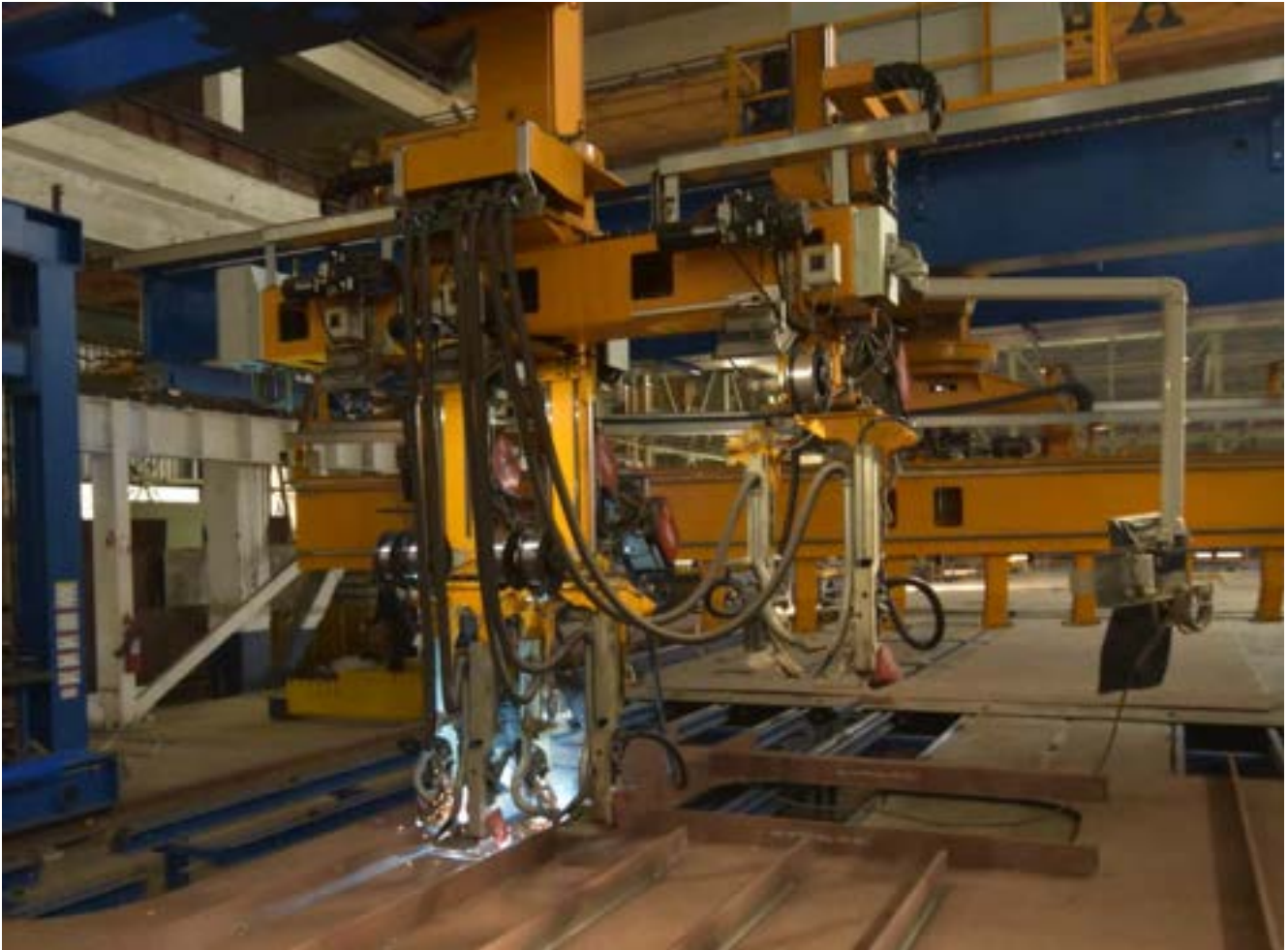
Proceso de soldadura automatizada durante la confección de un mamaparo estructural de un buque en construcción. Fotografía cortesía de Astilleros y Maestranzas de la Armada de Chile, Talcahuano (ASMAR).
