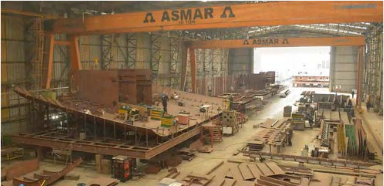
Fabricación de un bloque del buque antártico Almirante Viel al interior de un galpón dotado con toda la maquinaria adecuada para su confección. Posteriormente, una vez terminado el bloque, se moverá al exterior para su ensamble con otras secciones del buque. Fotografía cortesía de Astilleros y Maestranzas de la Armada de Chile, Talcahuano (ASMAR).
