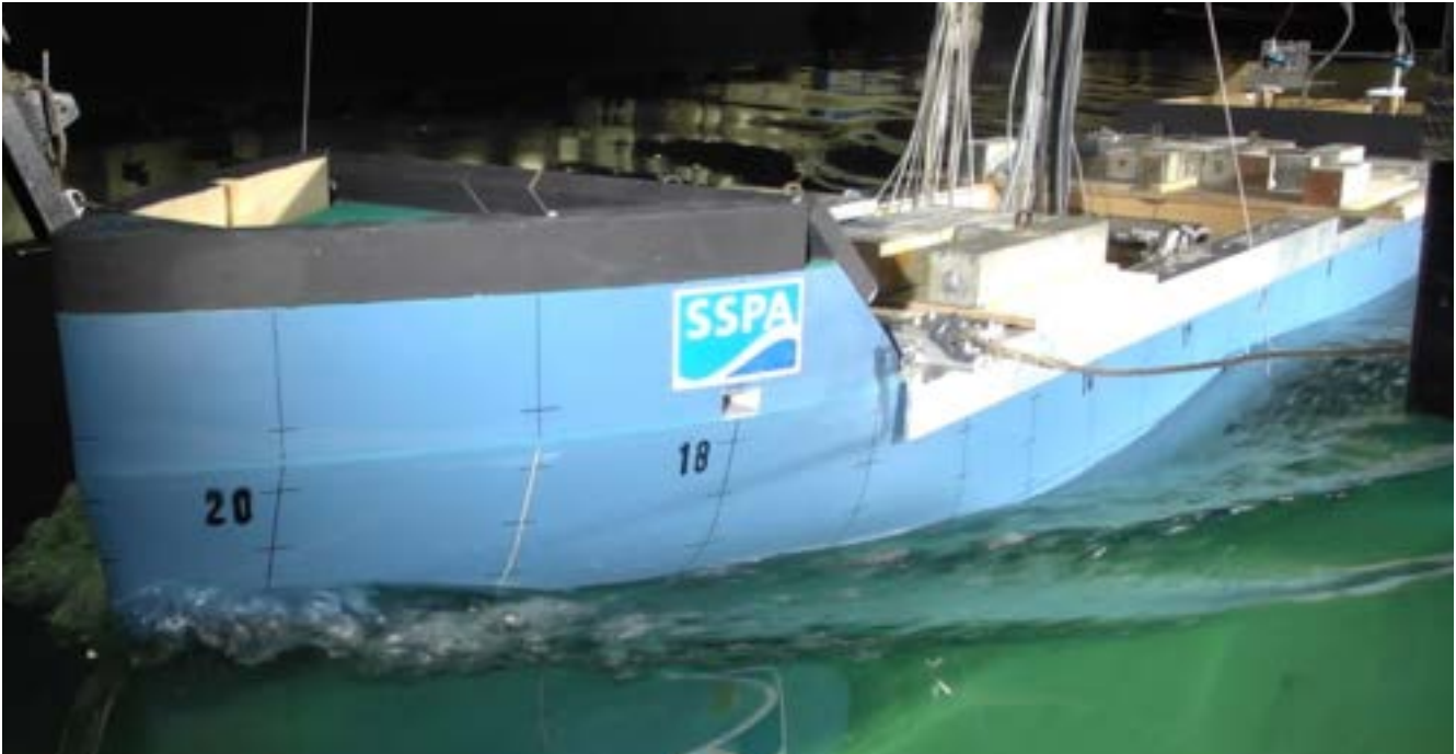
Modelo a escala de un buque, el cual se somete a pruebas hidrodinámicas en un canal artificial, con el propósito de evaluar el comportamiento del casco respecto al agua. Fotografía cortesía de Astilleros y Maestranzas de la Armada de Chile, Talcahuano (ASMAR).
