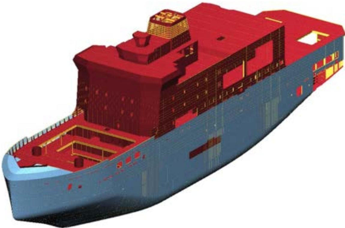
Modelo CAD de un buque en su etapa de ingeniería de detalle. Fotografía cortesía de Astilleros y Maestranzas de la Armada de Chile, Talcahuano (ASMAR).
