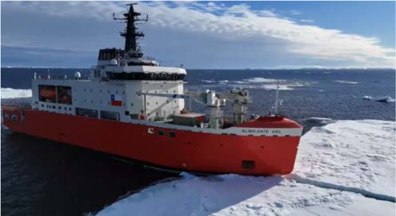
Buque rompehielos Almirante Viel durante la reciente campaña antártica de verano (2024/2025) efectuando sus pruebas de rompimiento de hielo de hasta 1,2 m de espesor. Esta prueba demuestra la tenacidad que deben tener los aceros utilizados para la construcción del casco de un buque de estas características. Fotografía cortesía de la Armada de Chile.
