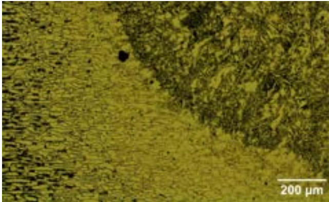
Figura N° 10. Soldadura en acero dúplex atacado con persulfato de amonio, observado con microscopía óptica.
