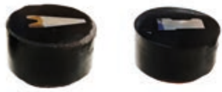
Figura N° 4. Muestras A y B, Aleación 1. Ataque con Nital 2%.
