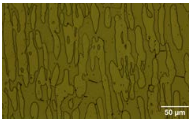
Figura N° 9. Acero dúplex atacado con ácido oxálico, observado con microscopía óptica.
