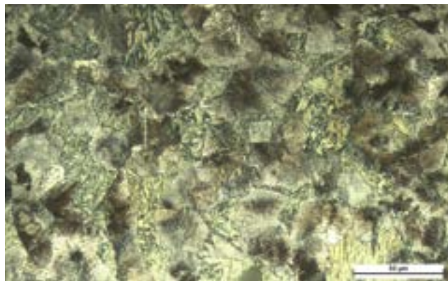
Figura N° 4. Acero de medio manganeso atacado con nital y metabisulfito de sodio, observado con microscopía óptica (Muñoz, 2024).
