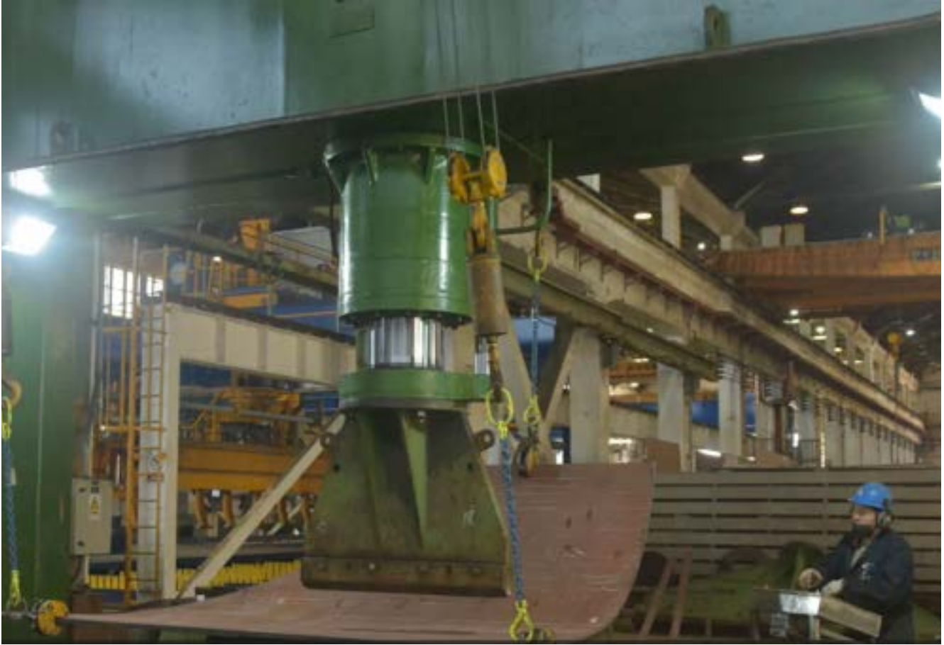
Proceso de conformado metálico de curvatura simple una sección del casco de un buque en construcción. Fotografía cortesía de Astilleros y Maestranzas de la Armada de Chile, Talcahuano (ASMAR).
