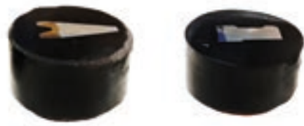
Figura N° 4. Muestras A y B, Aleación 1. Ataque con Nital 2%.
