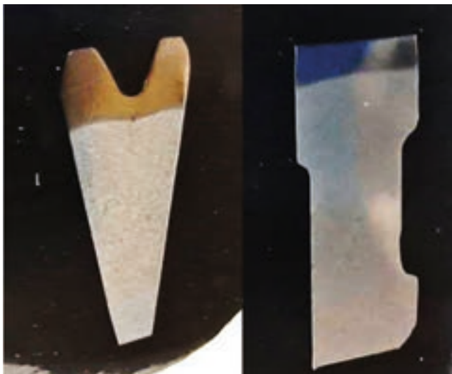
Figura N° 13. Aleación 1, muestras A (izquierda) y B (derecha). Atacadas en Nital 2%.
