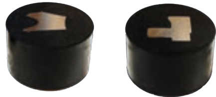
Figura N° 5. Muestras A y B, Aleación 2. Ataque con Nital 2%.
