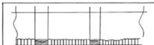
Figura 7 Formación de Anillos de Desgaste en interior Horno Rotatorio.
