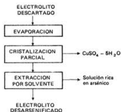
Fig. 3.3. Alternativa de remoción de As a través de extracción por solvente.
