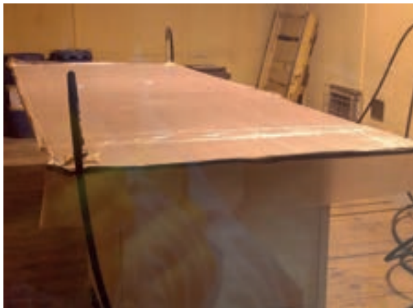
Figura N° 2. Plancha de GLARE durante el proceso de curado.
