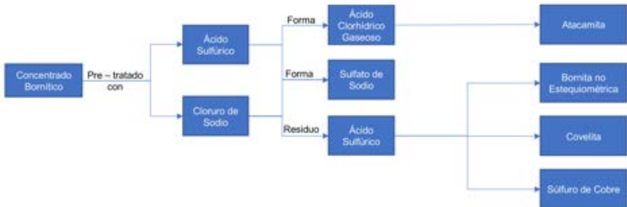
Figura N° 13. Resumen del mecanismo de acción de transformación de un concentrado bornítico a especies más solubles de cobre mediante un pre – tratamiento con ácido sulfúrico y cloruro de sodio.
