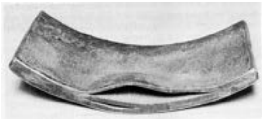
Figura 4. Sección transversal de una placa de acero al carbono perteneciente a una refinería de petróleo que falló por ampollamiento por hidrógeno [7].
