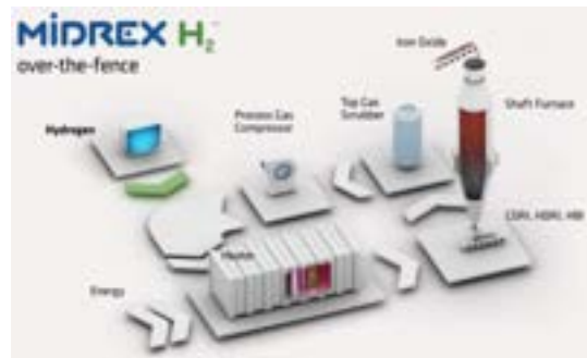
Figura 2. Proceso Midrex H 2 [13].
