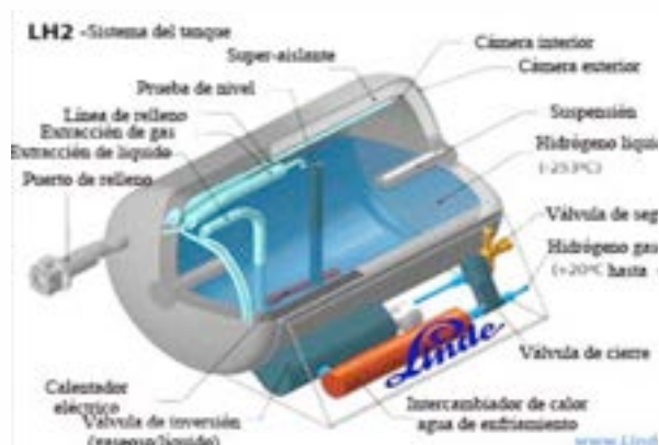
Figura 7. Contenedor criogénico y sus componentes [9].
