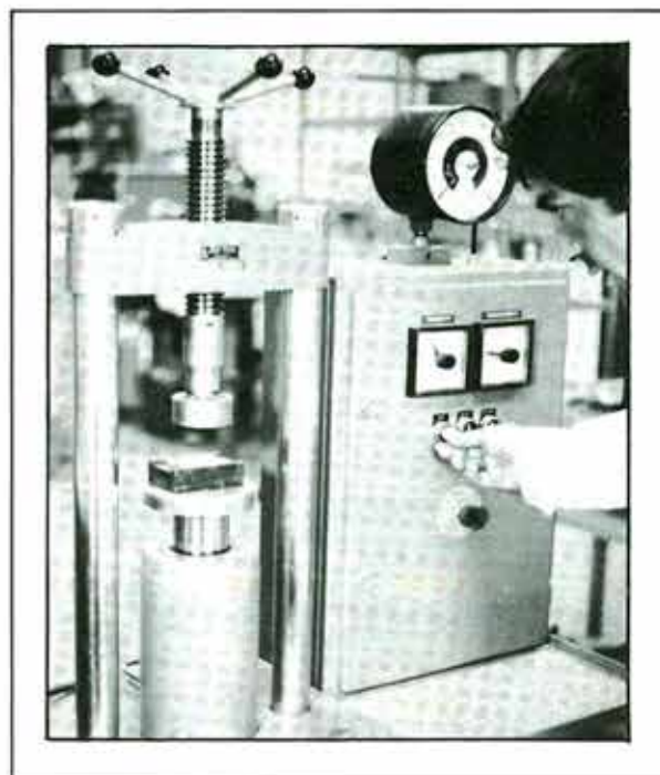
Figura 15.— Posionamiento del compactado de U_3O_8-Al o "caluga" en el marco de aluminio.
