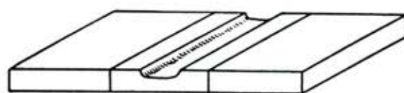
a) Visel preparado para depositar el metal de aporte
