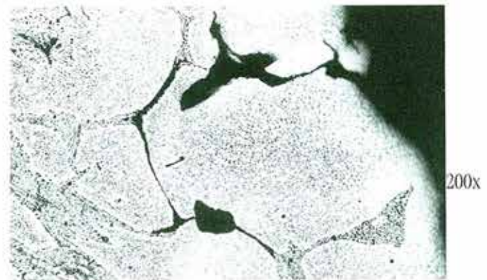
Figura 5.a.- Microfotografías de la muestra N°1, en la zona superficial.
