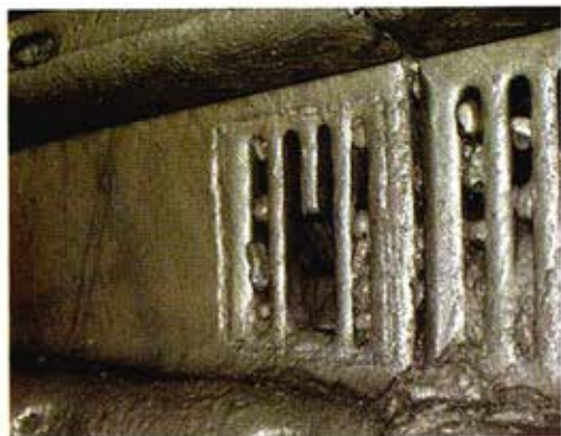
Figura 5. Parrilla fracturada en un molino semiautógeno.
