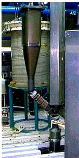
Fig. 3 Reactor, receptor de UF_4 , sistema de filtros y trampa de HF.
