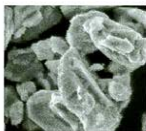
Fig. 5 Micrografías SEM en polvo de UF_4 [11].
