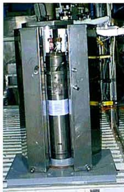
Fig. 2 Horno calefactor y cilindro de UF_6 .
