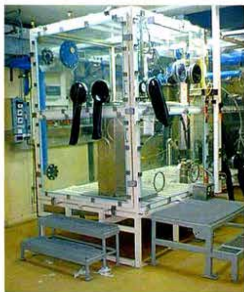
Fig. 1 Cabina de reducción de UF_6 a UF_4 empleando hidrógeno.
