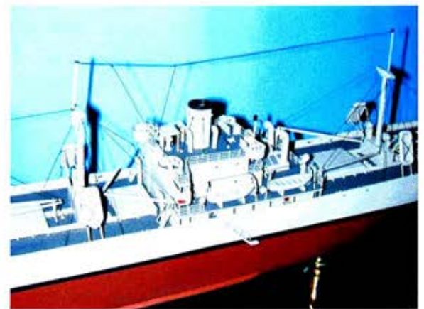
Figura 4. En esta maqueta se aprecian con mayor detalle las escotillas cuadradas.
