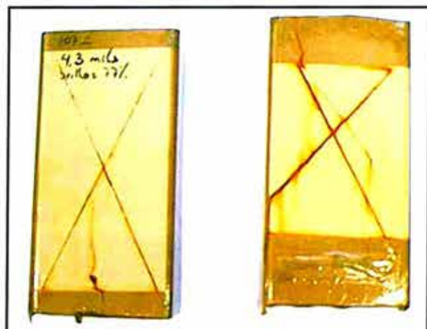
Figura 8. Acero al carbono recubierto con pintura del tipo alquídica como terminación.
