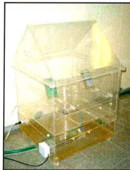
Figura 6. Vista exterior de la cámara de niebla salina.
