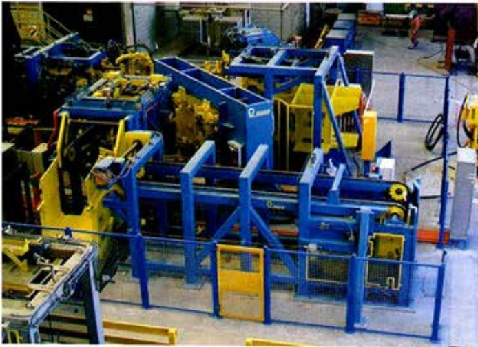
Figura 8. Máquina Preparadora de Anodos Aisco (tipo carrusel), alimentación de ánodos horizontal o vertical.
