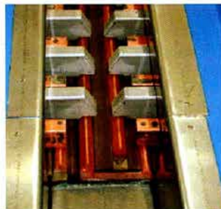
Figura 17. Sistema de Barras Interceldas de doble contacto Outokumpu. En la Planta de demostración.
