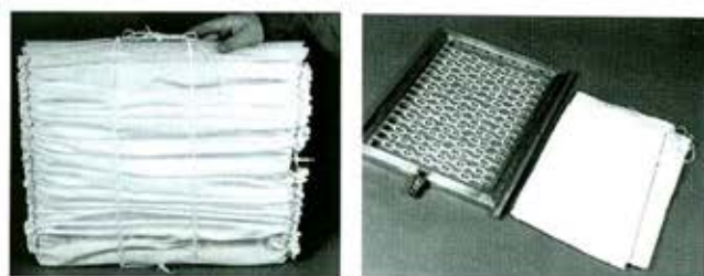
Figura 2: Fotografía Filtro Larox y su medio filtrante.
