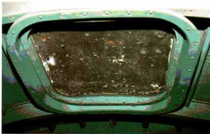
Figura 7. Ventana de un Comet, donde puede apreciarse la escasa distancia entre el borde y las hileras de remaches.
