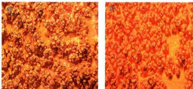
Figura 8. Morfología superficial del cátodo de cobre obtenido al utilizar Genapol PF-10 en dosis de a) 15 mg/L y b) 20 mg/L.
