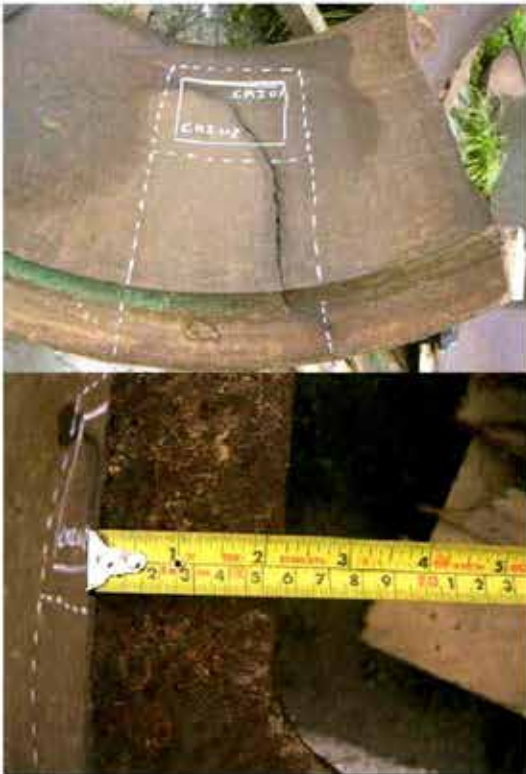
Figura 3.- Fractura y grieta de un revestimiento de chancador.
