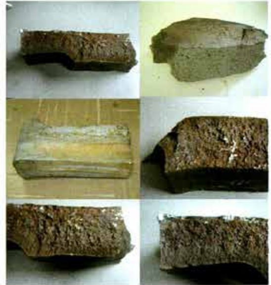
Figura 4.- Superficies típicas de fractura de revestimientos de chancador.
