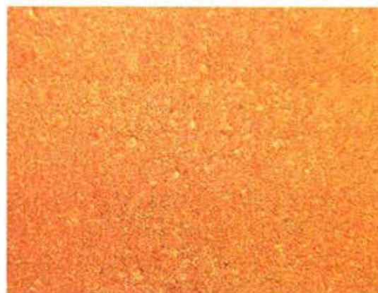
Figura 5. Morfología superficial del cátodo de cobre obtenido sin usar aditivos surfactantes.
