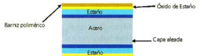
Figura 7.- Distintas capas que constituyen el recubrimiento de la hojalata.
