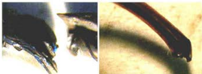
Figura 16. Imágenes fotográficas de fracturas debido a incrustaciones y/o inclusiones.
