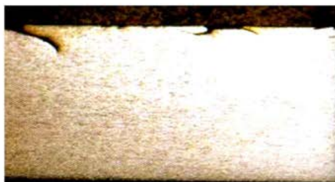
Figura 7. Micrografía de grietas superficiales, iniciadoras de cortes por pliegues.
