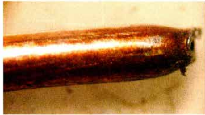
Figura 14. Imagen fotográfica de fracturas cono y copa con rayas de esmeril.
