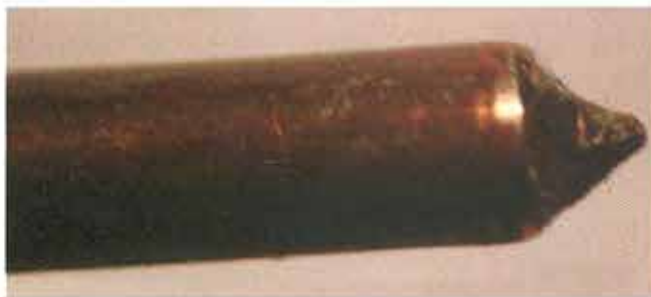
Figura 12. Imagen fotográfica de corte tipo cono y copa sin estricción.
