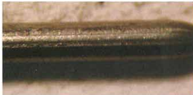
Figura 11. Imagen fotográfica de corte tipo cono y copa, debido a rayaduras de alambres.
