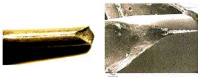
Figura 6. Imagen fotográfica y microscopía electrónica de barrido de corte debido a pliegues del alambre.
