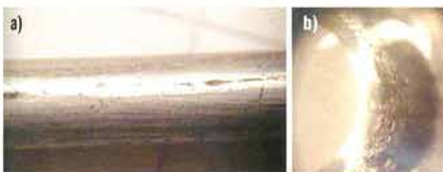
Figura 9. a) Daño superficial en el alambre del trefilado húmedo. b) Hilera con imperfecciones internas.
