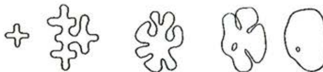
Figura 1. Evolución microestructural de dendrita a roseta [4].
