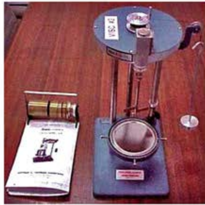
Figura 8. (a) Viscosímetro Stormer. (b) Esquema de un viscosímetro rotatorio.
