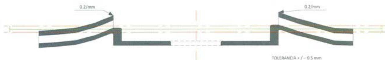
Figura 7 - Esquema en corte transversal de las mediciones de la deformación efectuadas sobre el disco superior. Para propósito comparativo también fue adicionada una escala con la tolerancia de deformación máxima permitida por el fabricante.
