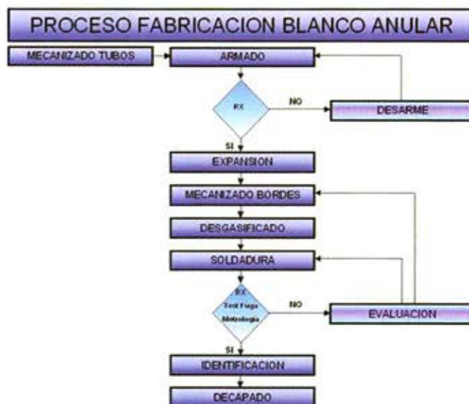
Figura 1. Procedimiento de fabricación de blanco anular.
