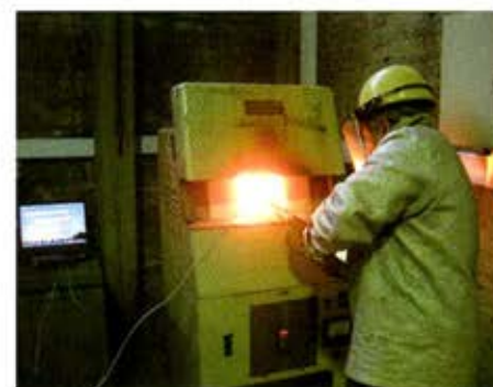
Figura 6. Horno Lindberg para homogenización, termocupla tipo k, interfase y PC.
