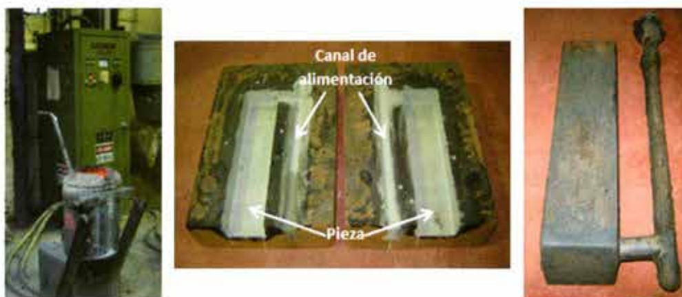
Figura 3. Horno de inducción, molde de arena con cromita recubierto con pintura de zirconio y producto del moldeado.
