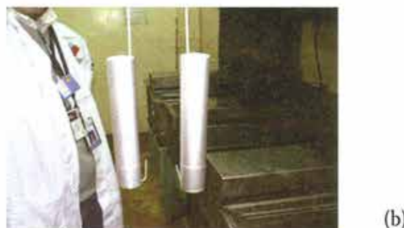
Figura 3. Limpieza de tubos de Al-3003.
