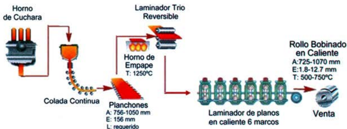
Figura 1. Proceso industrial de laminación en caliente.
