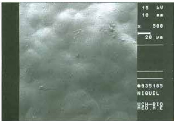
Figura 7. Micrografía de superficie de muestra 11.1.
