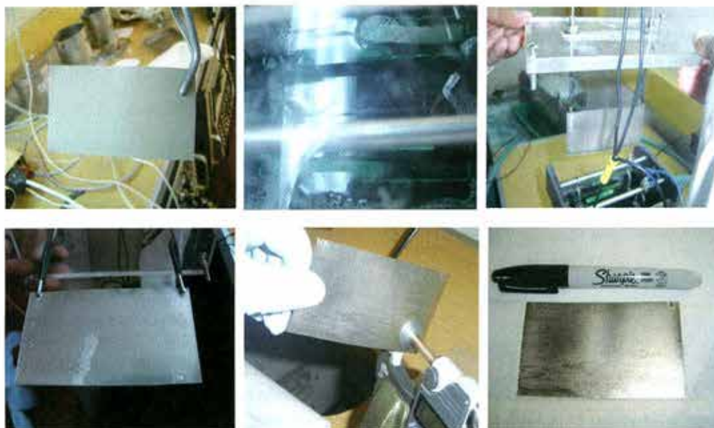
Figura 3. Secuencia de la electrodeposición de Ni en U.
