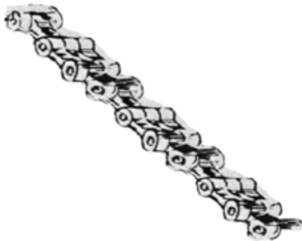
Figura N° 3. Adaptación esquemática de la idea de cadena extraída de los bocetos originales de Leonardo da Vinci (Church, 1921).
