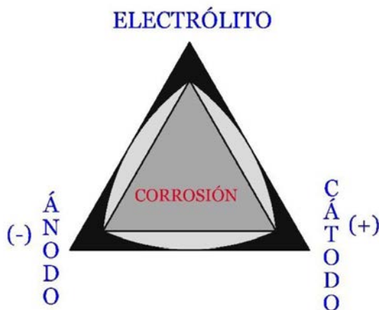
Figura N° 1: Triángulo de corrosión.
