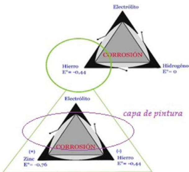
Figura N° 7: Escalones de protección contra la corrosión hasta la aplicación de pintura.
