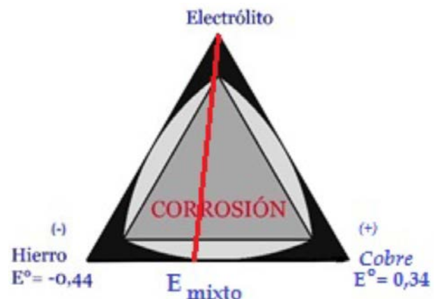
Figura N° 21: Triángulo virtuoso final para la cementación de cobre a partir de chatarra de hierro indicando tendencia de E_{corr} .
