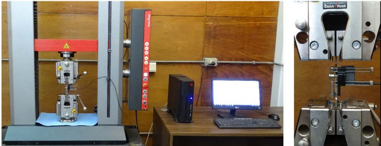
Figura N° 7. Ensayo estático de tracción. Fotografía de la máquina y detalle de zona de mordazas en instante previo al inicio del ensayo.
