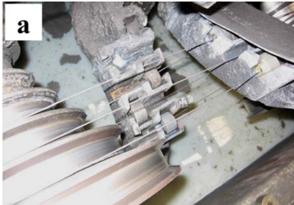
Figura N° 4a. Conos de trefilación en húmedo. a. Distribución de las hileras; 4b. hileras sumergidas en el baño durante el proceso.
